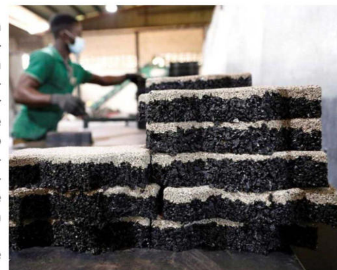
Tijolos de borracha, feitos da reciclagem de pneus
